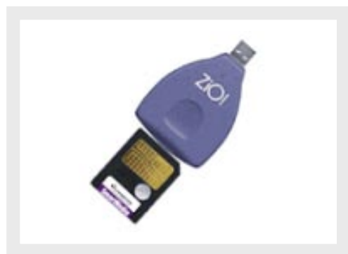
Figura 9 - Adaptadores para computadores normais, acessados com se fossem um outro disco rígido (HD).
