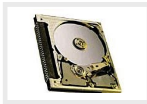
Figura 7 - Cartão "Compact flash", note que ele é um mini disco rígido de computador.
