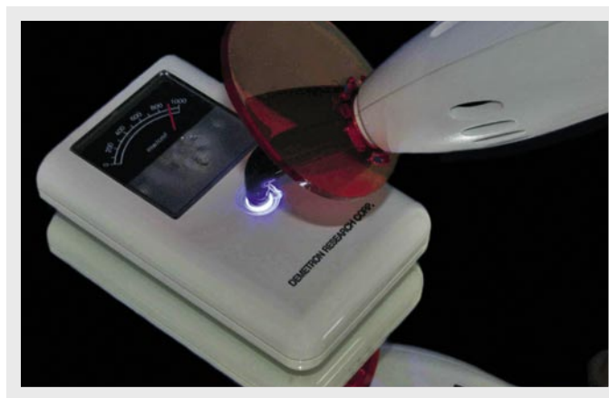
Figura 17 e 18 - Aparelho fotopolimerizador de diodo emissor de luz, LED Demetron (Danbury Connecticut, EUA).
