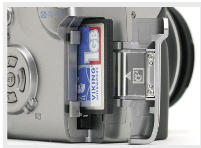
Figura 6 - Máquina Canon EOS 300D mostrando um cartão Compact flash de 1 gigabyte, capaz de tirar 300 fotografias em arquivo de melhor qualidade JPEG.
