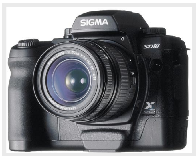
Figura 4 - Sigma SD 10, máquina fotográfica digital equipada com sensor Foveon X3. Vista frontal.
